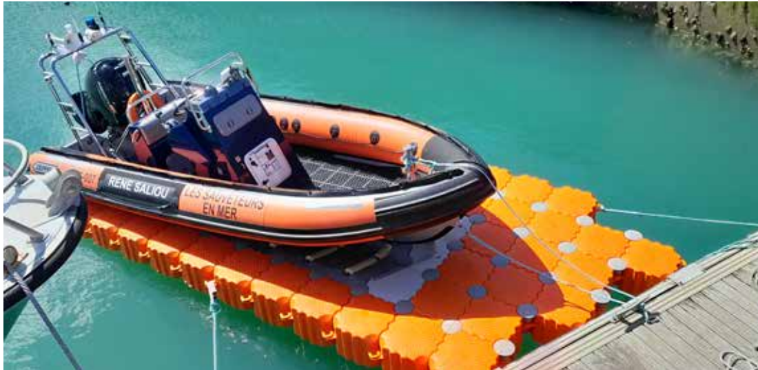
Dock pour une unité de la SNSM avec cubes oranges dédiés
