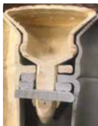
Vue en coupe d'une rotule reliant 4 cubes.
