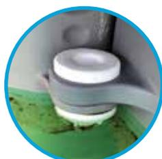
Compruebe visualmente que los tornillos de plástico blanco situados a ambos lados de la rampa de entrada están en buen estado. Son los tornillos que garantizan la integridad de la base al subir y bajar una embarcación. En caso de duda, cámbielos.
