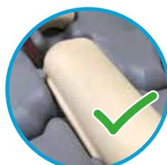
Si un cojín muestra signos significativos de desgaste, es aconsejable sustituirlo para garantizar la integridad del casco y las cunas de la embarcación. Para ello, desengancharlo con la llave y colocar uno nuevo.
