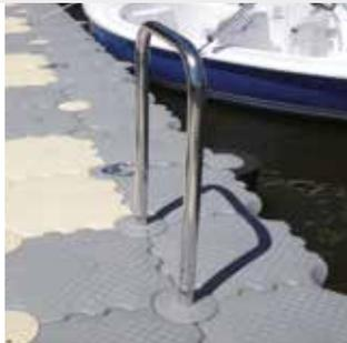
Fijación con retranqueo de 50cm, en la intersección de 4 cubos. Facilita el embarque / desembarque de pasajeros. Dimensiones (Ø x H): 4,2 x 110 cm / Peso: 8,00 kg. Acero inoxidable pulido. Montado sobre 2 pernos grises.
